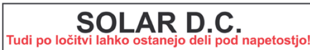
Slika 7.8: Oznaka delov pod napetostjo na osnovi
